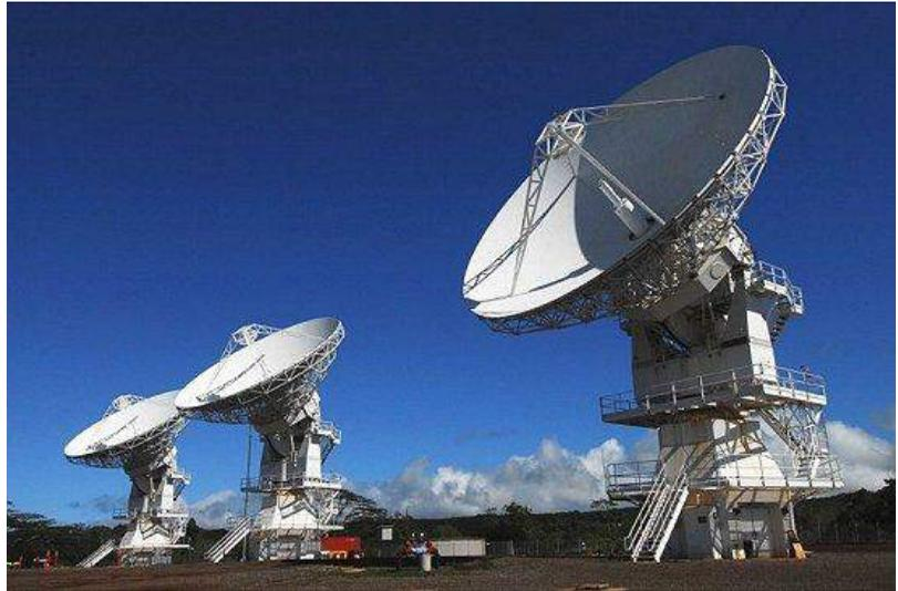
I **ponti radio**, invece, svolgono la funzione di collegamento fisso punto-punto e punto-multipunto, unidirezionale o bidirezionale fra 2 stazioni fisse; le antenne paraboliche di varia grandezza sono le più usate, sono fortemente direttive e utilizzano, per le trasmissioni, frequenze nel campo dei GHz (microonde). I livelli di potenza tipici di questo tipo di trasmissione sono dell'ordine del watt.
