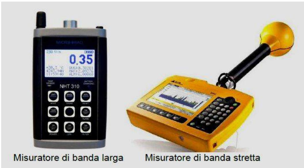
*Esempio di misuratori a banda larga e a banda stretta (fonte: ENEA)*
