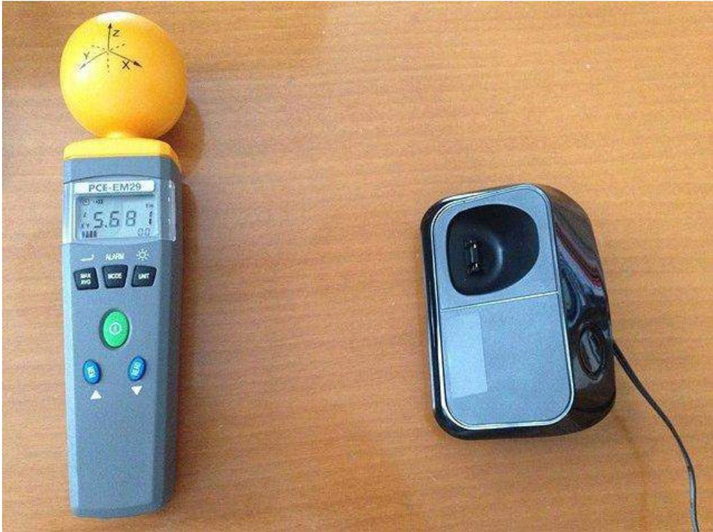
*Un misuratore RF modello PCE-EM 29 mentre misura il campo vicino alla base di un telefono cordless DECT. Si noti il valore di campo elettrico assai elevato prodotto, pari a 5,6 V/m a poca distanza dalla base. (fonte: [www.onde-invisibili.it](http://www.onde-invisibili.it))*
