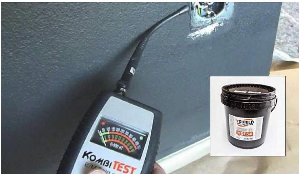
*Test di una vernice a base di nanopolveri metalliche per la schermatura dei campi elettromagnetici quando vi sono esigenze estetiche.*
