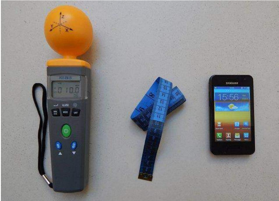
*Quando si effettua la misurazione del campo elettrico prodotto da un cellulare in chiamata è sempre bene misurare la distanza fra misuratore RF e telefonino. In questo caso lo smartphone non è in chiamata, per cui il campo è il fondo: 10 mV/m.*
