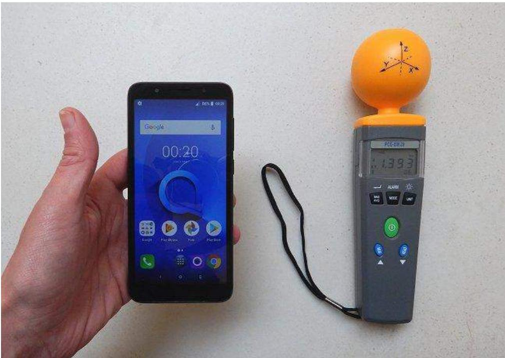
*Prima di acquistare un telefonino sarebbe bene testarlo con un misuratore RF, rispetto ad altri modelli, e nella stessa stanza, poiché anche la distanza dalla stazione radio base influisce moltissimo sulla potenza prodotta da un apparecchio.*
