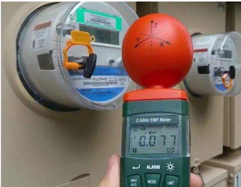
*I contatori “intelligenti” vanno controllati sia alle alte che alle basse frequenze (ELF).*
